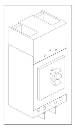
FIGURE 31. RA412S3 CIRCUIT BREAKER
