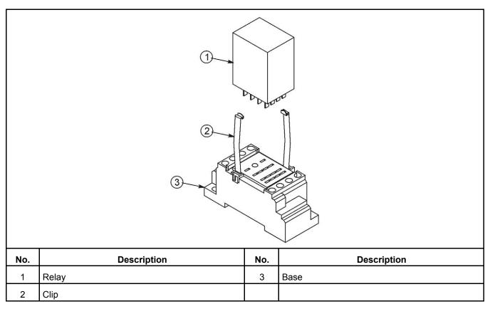
FIGURE 29. CONTROL RELAY INSTALLATION
