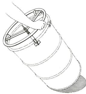
El volante es construido con tubos de acero (IRAM 228) vinculados entre sí mediante el sistema de soldadura MIG. A fin de prevenir el deterioro por efecto de la corrosión la herramienta cuenta con un tratamiento de pasivado, un recubrimiento de pintura epoxi por electrodepositación en el exterior y un aceite protector anticorrosivo en su interior.
