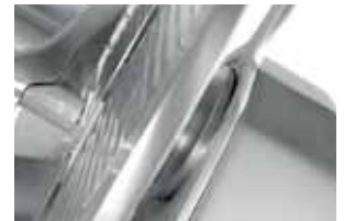
Protezione paracqua su puleggia Enclosed and sealed belt pulley
