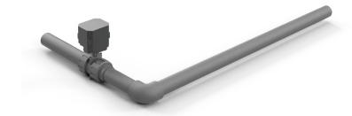
1.5" ACTUATED BALL VALVE IS INSERTED IN-LINE ON THE TANK DRAIN LINE
