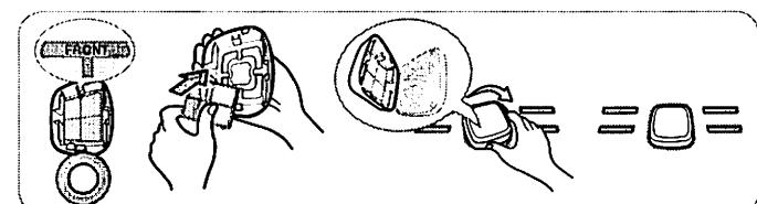
Luego de cambiar el filtro, mantenga pulsado el botón del "Filtro de aire fresco" durante tres segundos para restablecer el sensor del filtro.
