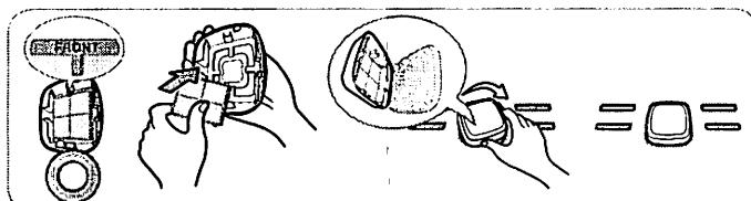
Après avoir changé le filtre d'air, appuyer pendant trois secondes sur le bouton du Filtre d'air pour réinitialiser le senseur du filtre.
