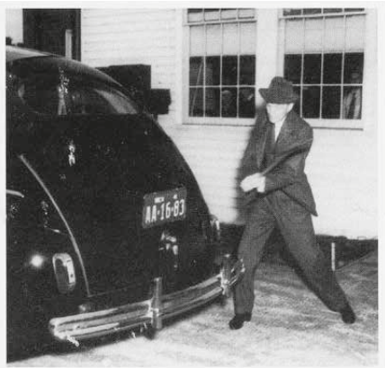
Henry Ford demonstriert im Jahre 1941 die Stabilität einer auf Sojabohnen-Basis hergestellten Autokarosserie.
