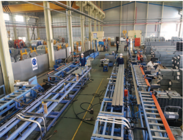
C형강 C형강으로 성형하기 전 유압 프레스로 원하는 사이즈 및 위치에 타공 작업을 진행하여 C형강을 생산하는 설비
