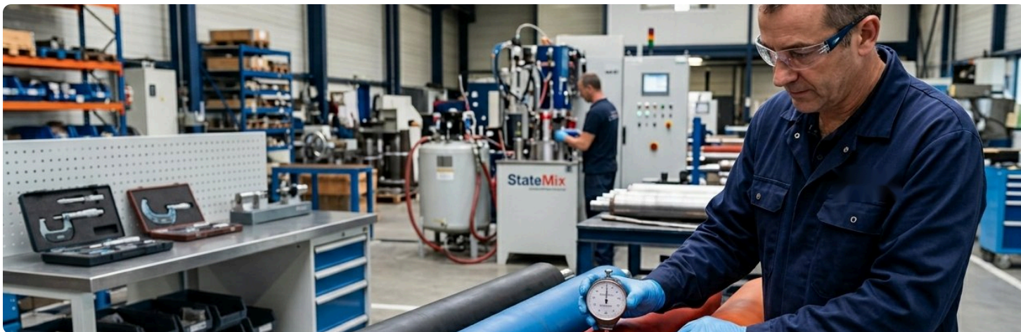
Atelier Soremag — coulée à chaud et contrôle dureté des rouleaux et pièces moulées en polyuréthane.
