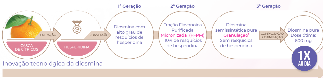
Figura 14 - Processo de obtenção da Diosmina mais pura.
