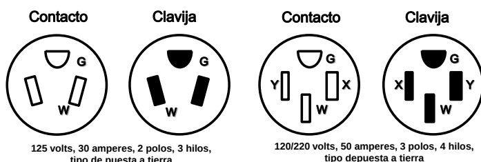
Figura 552-44(c)(1).- Configuraciones para contactos y clavijas del tipo con puesta a tierra.
