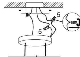
Connectez le fil de phase et le fil neutre au moyen des capuchons de connexion fournis (5). Connectez le fil blanc du luminaire au fil neutre de la boîte de connexion au plafond. Connectez le fil noir au fil de phase de la boîte de connexion au plafond. Connectez le fil de terre en cuivre nu sur la vis verte du support.
