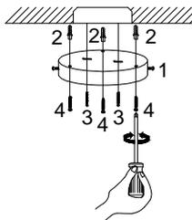
Percez dans le plafond les trous destinés aux ancrages de plastique (2). Insérez les ancrages de plastique fournis dans les trous que vous venez de percer. Fixez le support à l'aide des 5 vis fournies. Les vis de 19 mm [3/4 po] (3) doivent être vissées dans la boîte de connexion. Les vis de 29 mm [1 1/8 po] (4) doivent être vissées dans les ancrages de plastique.
