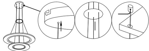
Tous les câbles de soutien devraient être à la même hauteur. Poussez les contre-écrous vers le haut pour déverrouiller les câbles et tirez ceux-ci au besoin. Lorsque vous avez réglé la hauteur, relâchez-les et serrez la vis à tête hexagonale au moyen de la clé Allen à l'intérieur du pavillon pour verrouiller l'écrou et maintenir les câbles en place.
