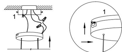
Fixez le pavillon du luminaire au support en faisant glisser le couvercle du luminaire sur le support à l'endroit où il y a des vis en saillie sur le côté, puis en le tournant pour le verrouiller en place.
