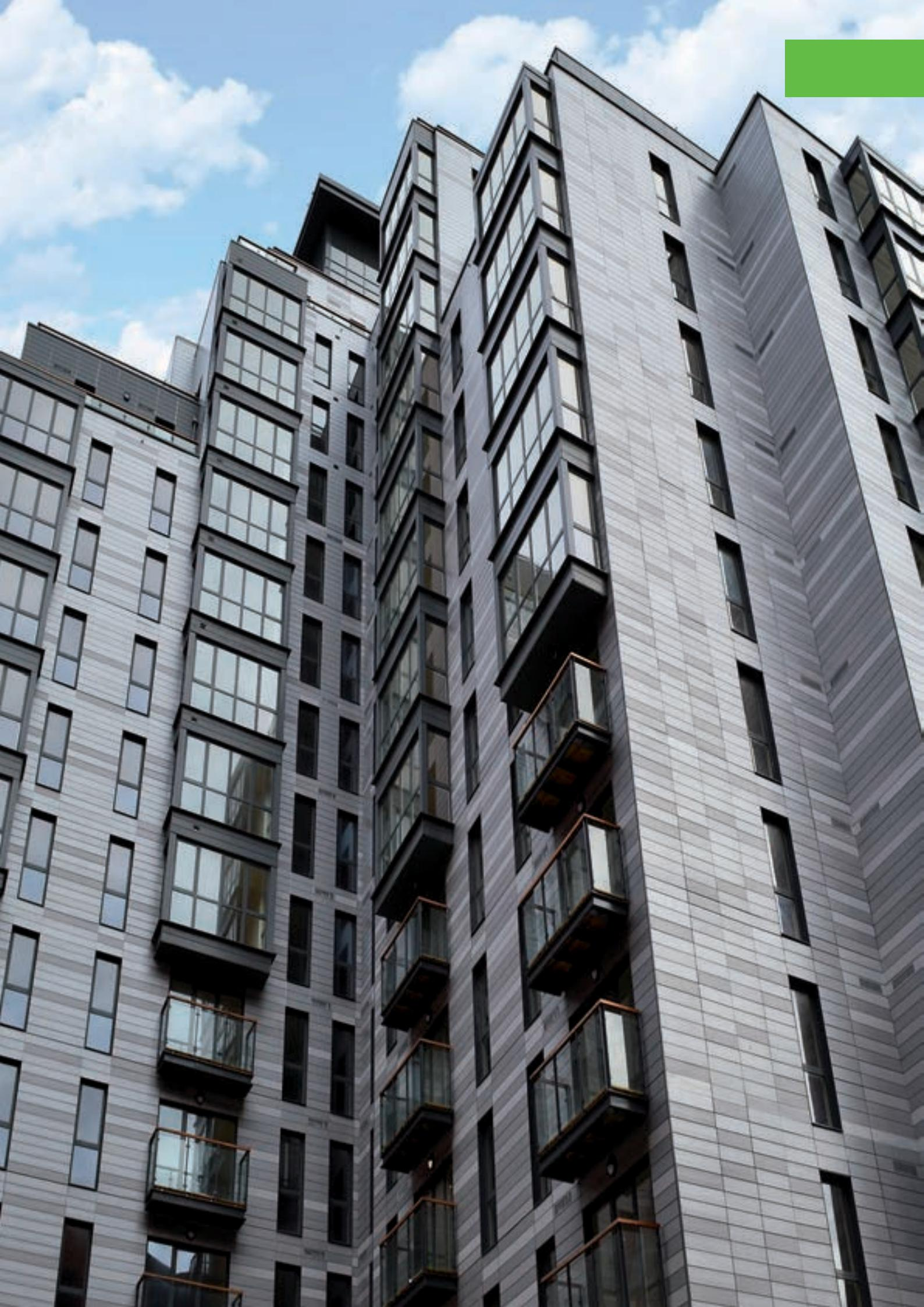
**IT** Alucovering® by ALIVA® rappresenta sul mercato la risposta architettonica più completa e tecnologicamente più avanzata alla richiesta di rivestimenti di facciata in Parete Ventilata con lastre in lega di alluminio estruso.
