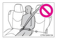
N'utilisez pas la ceinture de sécurité du siège central de deuxième rangée si l'une des 2 boucles est déverrouillée.
