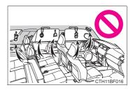
Véhicules dépourvus de système d'accès "mains libres": ne fixez pas des objets lourds, pointus ou très durs, comme des clés et des accessoires par exemple. Ces objets risquent d'entraver le déploiement du coussin gonflable de genoux SRS ou d'être projetés vers le siège conducteur par la force de déploiement, constituant ainsi un danger potentiel.
