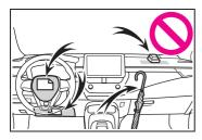
Ne fixez rien aux portes, à la vitre du pare-brise, aux vitres latérales, aux montants avant et arrière, au rail latéral de toit et à la poignée de maintien. (Sauf pour l'étiquette de limitation de vitesse)
