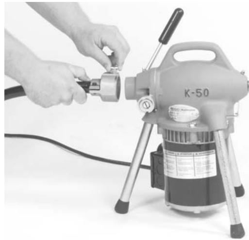
Figure 2 – Montage du guide-câble arrière
