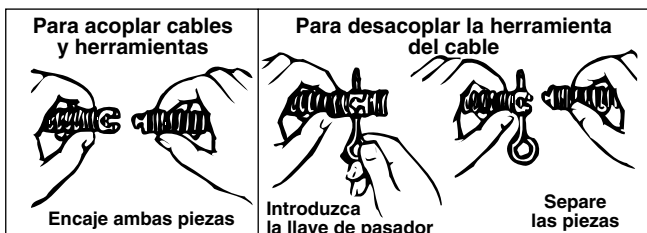
Figura 4 – Modo de acoplar y desacoplar herramientas y cables
