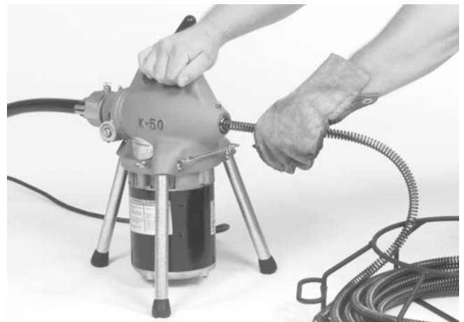
Figure 3 – Introduction du câble par l'avant de la machine
