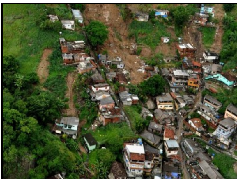
Deslizamento de lixo acumulado irregularmente em encosta. Morro do Bumba – Niterói
