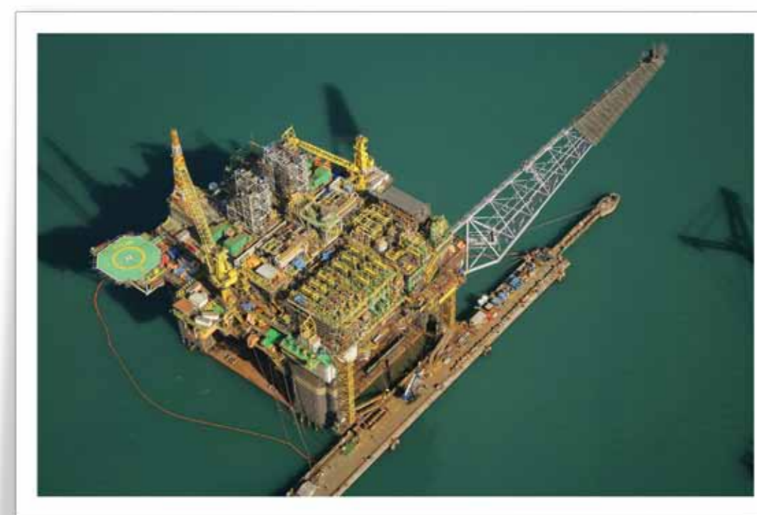
Etapa final de construção de plataforma semi-submersível P-52 em estaleiro no Rio de Janeiro.
