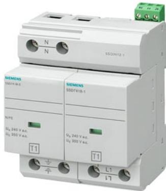
Pararrayos tipo 1 Clase de exigencia B, UC 350V Módulos de protección enchufables 2 polos, circuito 1+1 para sistemas TN-S y TT con visualizador remoto
