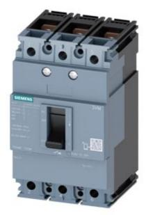
Interruptor automático 3VM1 IEC Frame 100 Clase de poder de corte B Icu=16kA @ 415V 3 polos, protección de distribuciones TM210, FTFM, In=80 A protección de sobrecarga Ir=80 A invariable protección de cortocircuito Ii=10 x In conexión plana con tornillos
