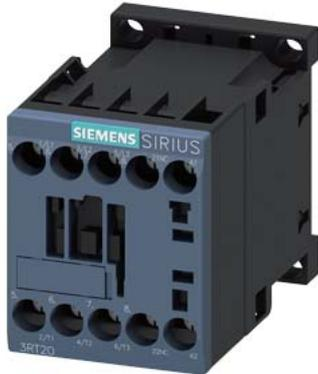
Contactor de potencia, AC-3 9 A, 4 kW/400 V 1 NC, 220 V AC, 50/60 Hz 3 polos, tamaño S00 conexión por tornillo
