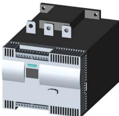
Arrancadores suaves SIRIUS Valores con 400 V, 40 °C Estándar: 356 A, 200 kW Contacto común a 3: 617 A, 355 kW 200-460 V AC, 230 V AC bornes de tornillo !!! Producto a extinguir El sucesor es SIRIUS 3RW5, El tipo sucesor preferido es >>3RW5546-6HA14<<
