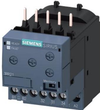
relé de vigilancia, adosable a contactor 3RT2, Tamaño S00 Basic, ajuste analógico vigilancia de corriente aparente 1,6-16 A, 20-400 Hz, 2 fases Alimentación 24-240 V AC/DC 1 conmutado Vigilancia de rebase por exceso o defecto de la intensidad pérdida de fase, rotura de hilo con o sin memoria de fallos Retardo de arranque 0-60 s Supresión de picos perturbadores 0-30 s Histéresis de conmutación 6 % sistema de conexión por tornillo
