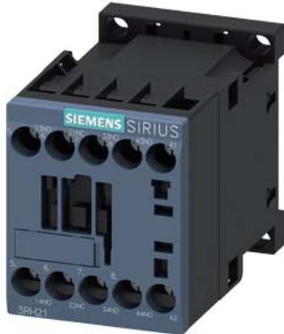
contactor auxiliar, 3 NA + 1 NC, AC 110 V, 50 / 60 Hz, Tamaño S00, borne de tornillo
