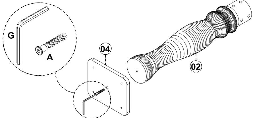
4º - Fixe as sapatas redondas a parte de baixo dos pés utilizando parafuso 3,0x12 Ch. Ph. c/p.
