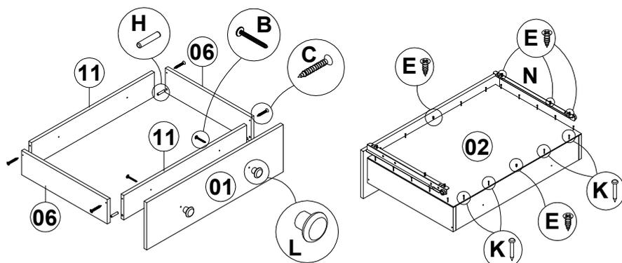
**11º** - Alinhe as gavetas e fixe os fundos traseiros juntamente com o perfil "I" utilizando prego 8x8.
