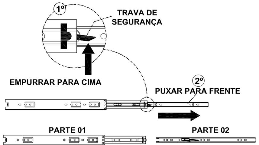
8º - Parafuse a parte "01" das corrediças na lateral direita e na lateral esquerda inferior do gaveteiro, seguindo as marcações, usando 03 parafusos CH PHS 3,5x12 c/ pont.
