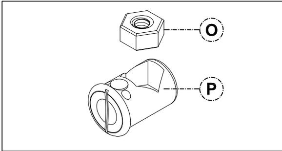
25° - Encaixe as buchas com as porcas nas furações da grade lateral de modo que, no momento da montagem, o **parafuso passe primeiro pela bucha e depois pela porca**, conforme desenhos a seguir:
