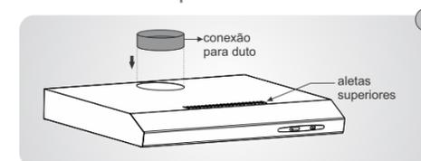
A) Encaixar a conexão para duto no depurador (MODO EXAUSTOR). Caso opte pelo modo depurador, utilizar a tampa plástica que acompanha o produto, para tampar a furação.
