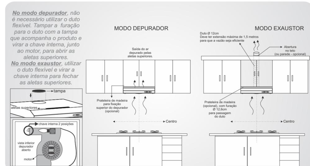
NOTA: Para fixação, centralizar o depurador ao fogão. Com uma trena, achar a altura entre o fogão e a base do depurador, conforme indicado neste manual (65 a 80 cm). O duto não deve ultrapassar 1,5 metros até a saída externa, para que a vazão de ar seja eficiente.
