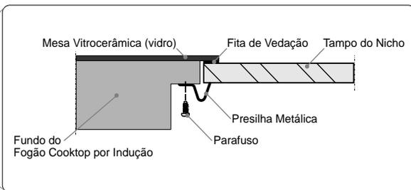
Detalhe instalação da presilha metálica
