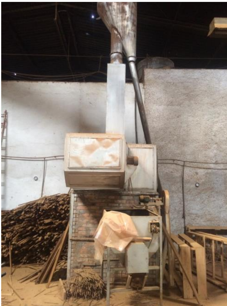
FOTO 01 - Estufa marca SULAR, para secagem de madeira, modelo reversível, ano 2002
