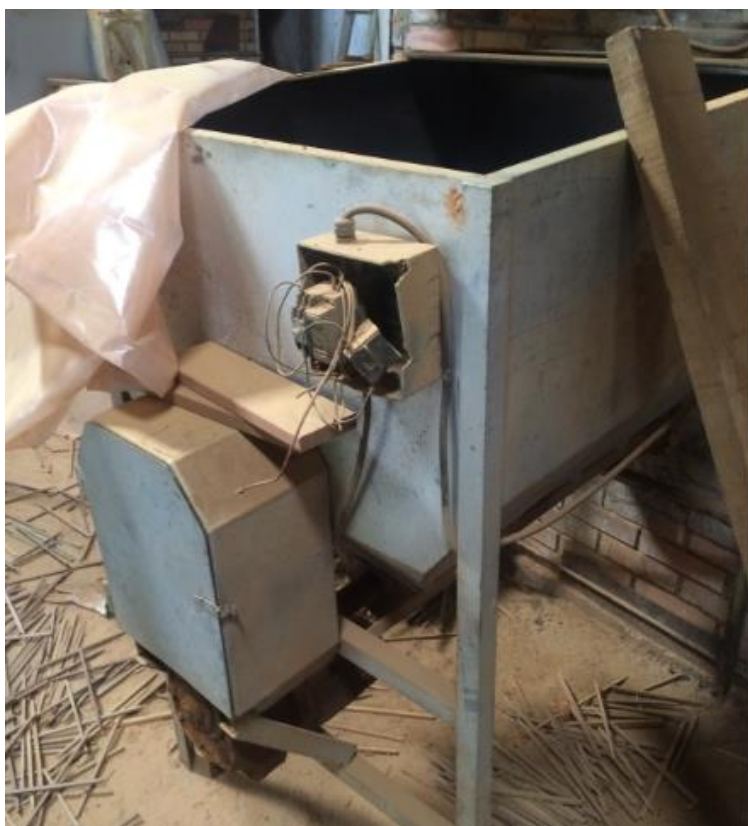
FOTO 03 - Alimentador automático de maravalha.
