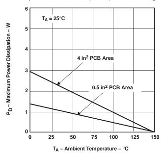
Figure 24. SOT223 Power Dissipation
