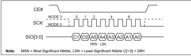
FIGURE 5-22: BLOCK-ERASE SEQUENCE (SPI)
