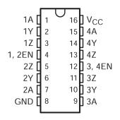
Figure 4-1. D, N, or NS Package (Top View)
