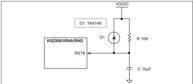
FIGURE 8-1: RECOMMENDED RESET CIRCUIT
