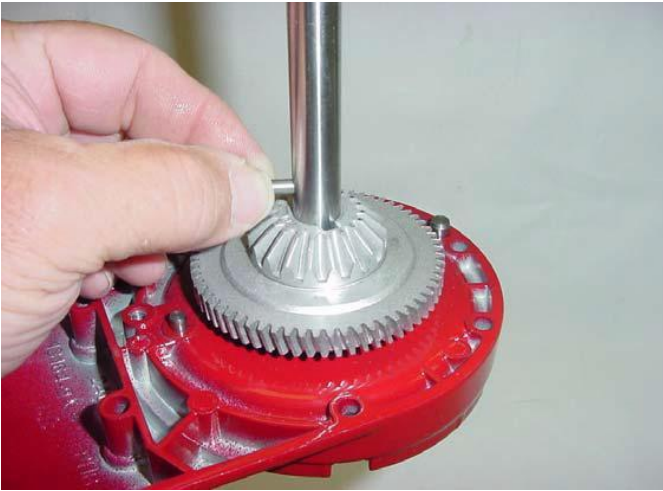
Fig. 53) Remove the center gear drive pin.
