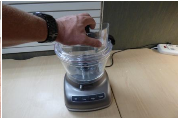
Fig. 24) Test Safety Switches
