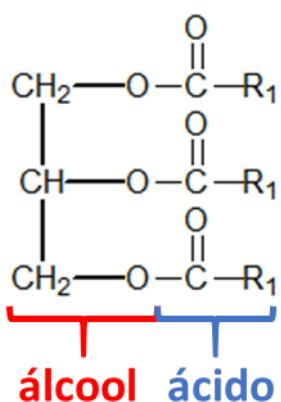
A reação do triacilglicerol com o etanol é uma transesterificação, em que o etanol toma o lugar do glicerol, produzindo um éster do etanol com o ácido graxo, que é o biodiesel.
