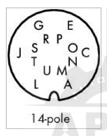
Pin A, L: 0.75 mm<sup>2</sup> Pin C - J, N - T: 0.34 mm<sup>2</sup>
