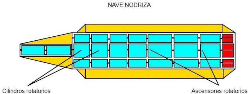
En este esquema podemos ver cómo sería una nave nodriza vista desde arriba, se puede observar que los cilindros rotatorios están puestos en el interior del casco y en posición paralela a la trayectoria de la nave, de este modo se evita por un lado que el movimiento de los cilindros repercutan en la estabilidad del casco exterior, y por el otro se evita que los acelerones o frenazos desestabilicen la gravedad interior.
