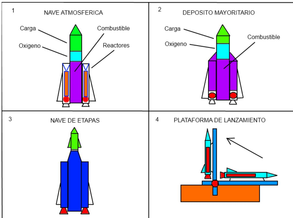
En el ejemplo número uno se muestra el modelo de nave atmosférica, este tipo de nave es de etapa única y cuenta con la ventaja de llevar dos motores turbo reactores que se sirven del oxígeno atmosférico para cumplir la misión. Esto le permite un gran ahorro de combustible al no tener que transportar la mayor parte del oxígeno necesario.
