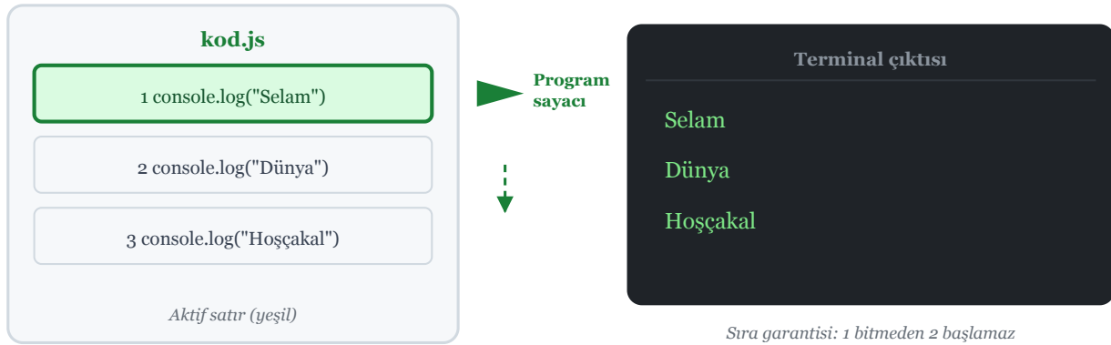
ŞEKİL Z.1.3 Sequential execution: program sayacı (pointer) her satırı sırayla işler
