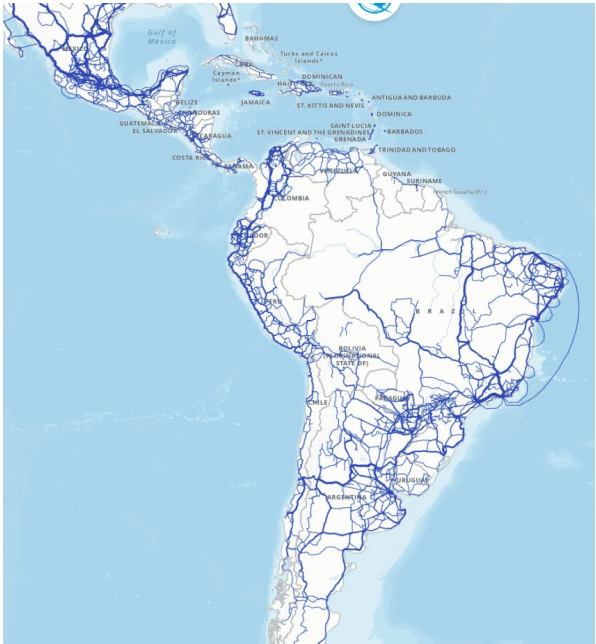
Figura 6. Cables de fibra óptica en tierra; detalle para latinoamérica y el caribe.
