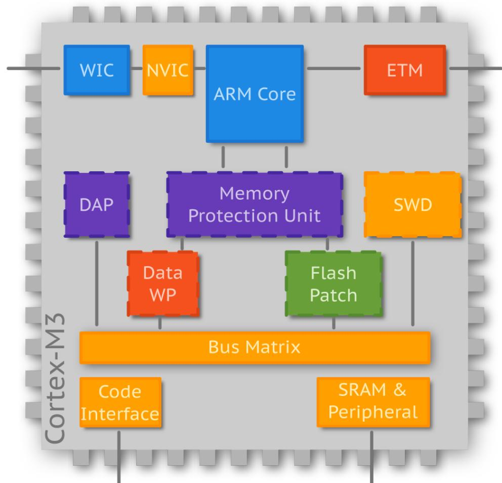
Любое устройство воспринимается микроконтроллером как модуль памяти, хотя физически таковым может и не являться. Память программы, оперативная память, регистры устройства ввода-вывода — все они находятся в едином адресном пространстве. Структура адресного пространства Cortex-M3 закреплена стандартом и не изменяется от производителя к произ-
