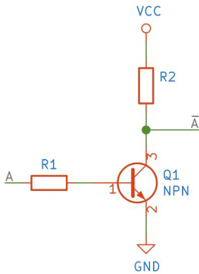
Операция НЕ унарная, т.е. требует всего одно значение. Если мы подадим на базу низкое напряжение, то транзистор будет закрыт. Снимая напряжение на коллекторе, мы получим высокий уровень. И наоборот, открыв транзистор (высокое напряжение на базе), мы замкнем цепь на землю, т.е. напряжение на коллекторе будет низким.
