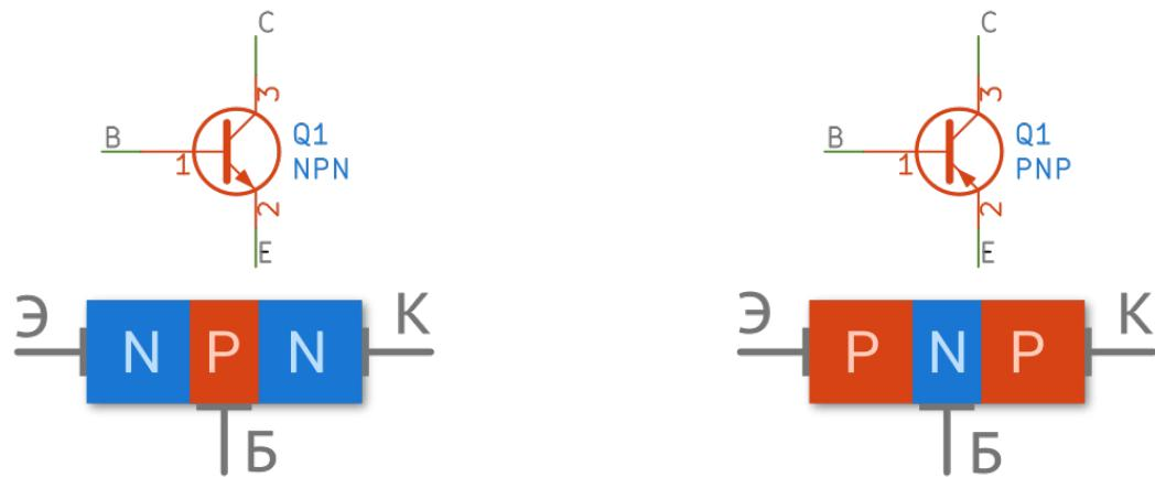
Электрод, подключенный к середине, называют базой (англ. base), другие два — коллектором (англ. collector) и эмиттером (англ. emitter). Стрелка на эмиттере указывает направление тока.
