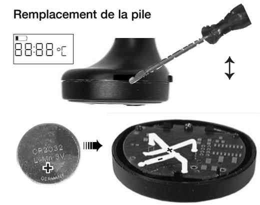
Si le signal apparaît pendant la mesure, les piles doivent être changées. Sortez la pile usagée en la faisant glisser, et remplacez-la par une nouvelle. **Respectez les polarités!**
