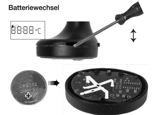
Batteriewechsel wird erforderlich, wenn während der Messung das Symbol in der Anzeige erscheint. Gehäuse mit Hilfe eines Schraubendrehers öffnen. Verbrauchte Knopfzelle herauschieben. Neue Knopfzelle einlegen - **Polung beachten!**
