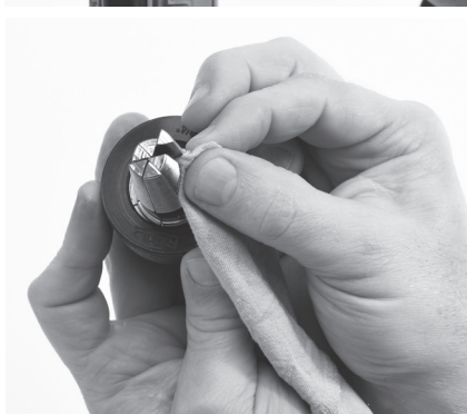
Figure 10 – Nettoyage des têtes d'évasement
