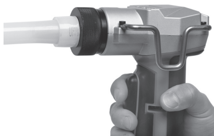
Figura 7 B – Final de la expansión del tubo, con el extremo del tubo al ras con el hombriillo del cabezal de expansión
