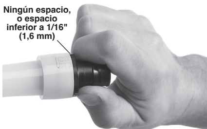
Figura 9 – Introducción del acoplamiento dentro del tubo
