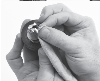
Figura 10 – Limpieza del cabezal de expansión
