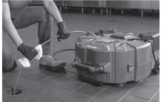
Figura 15 – Limpieza del cable con un paño durante la recuperación
