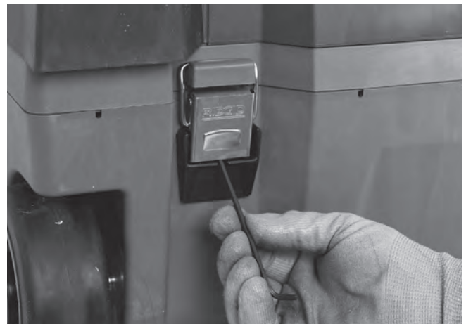
Figura 19 – Apertura del retén debajo del mango de transporte. Use una llave hexagonal.
