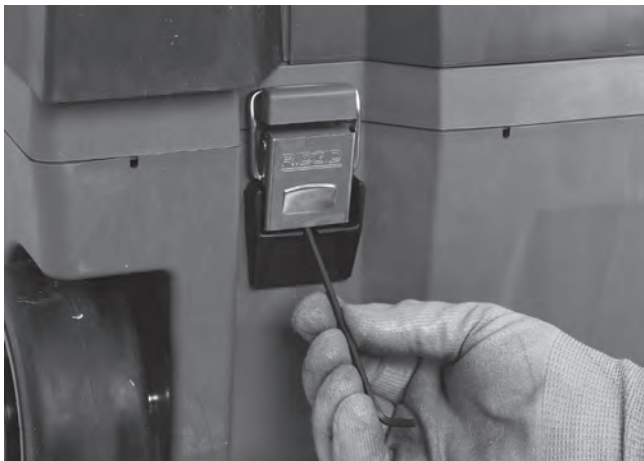
Figure 19 – Ouverture du loquet sous la poignée avec clé Allen
