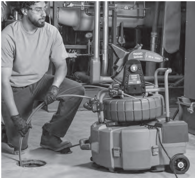
Figura 10 B – Carrete SeeSnake® Compact montado sobre la máquina FlexShaft KM-1004
