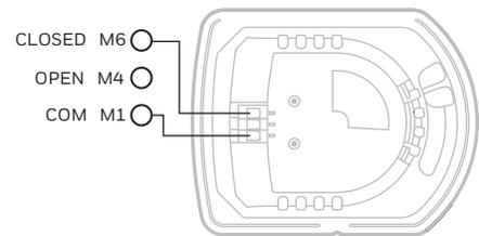
NOTE: WHEN INSTALLING ON OLDER MASTERROL BOARDS SUCH AS THE MARK V, JUMPER M2-M5 ON THE PANEL.
