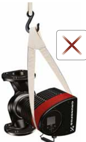
Fig. 2 Elevación incorrecta de la bomba
