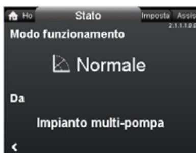
Fig. 57 Exemple du sous-menu « Etat de fonctionnement » signalant que le circulateur fonctionne en mode normal dans une installation à circulateurs multiples.
