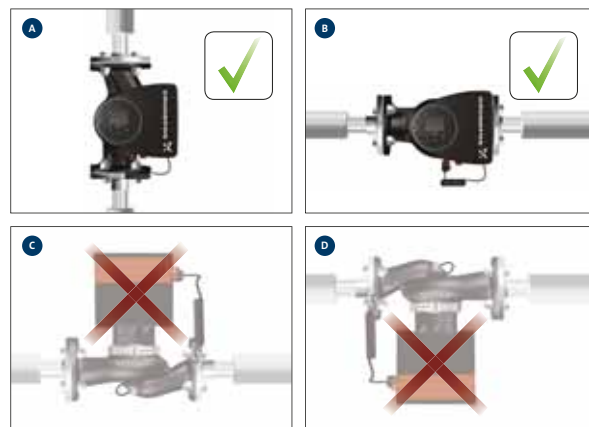
Fig. 6 Circulateur installé avec un arbre moteur horizontal
