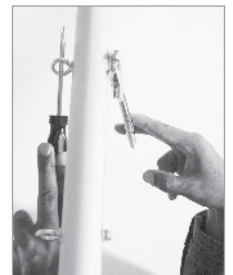
Figura 8: Usare due dita per stringere i bulloni
