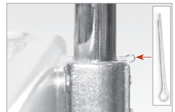
Figura 5: Coppiglia prima e dopo la rimozione dal Trapeze Table.
