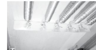
Figura 3: Resortes enganchados hacia abajo
