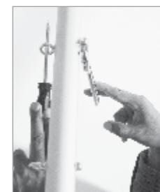
Figura 9: Usar dos dedos para apretar los tornillos.
