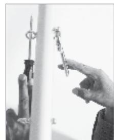
Figure 9: Serrez les boulons avec deux doigts
