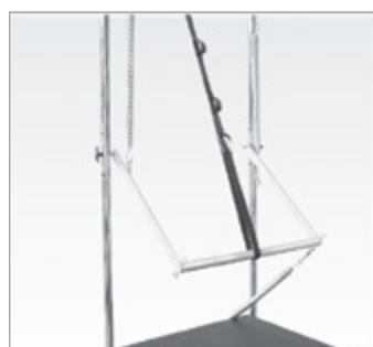
Figura 7: Correa de seguridad que sujetla la barra de empuje en la posición de 4 en punto. La correa se sujetla a la PTB y al marco de la cubierta, no a los cáncamos.
