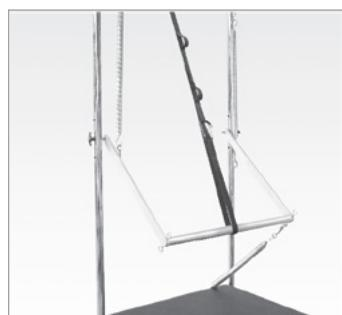
Figure 7: sangle de sécurité maintenant la barre traversante à 4 heures. La sangle est fixée au cadre PTB et à la structure, pas aux boulons à œil.
