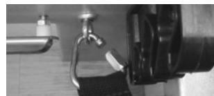
Figure 2 : mousqueton correct : Aucune usure du crochet.
