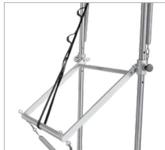
Figura 6: Correa de seguridad que sujetla la barra de empuje en la posición de 4 en punto. La correa se sujetla a la PTB y al marco de la cubierta, no a los cáncamos.
