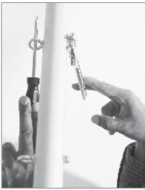
图9：用两根手指紧固螺栓
